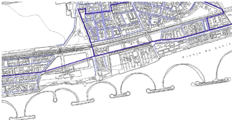
Xarxa bàsica i secundària d'aigua potable.
